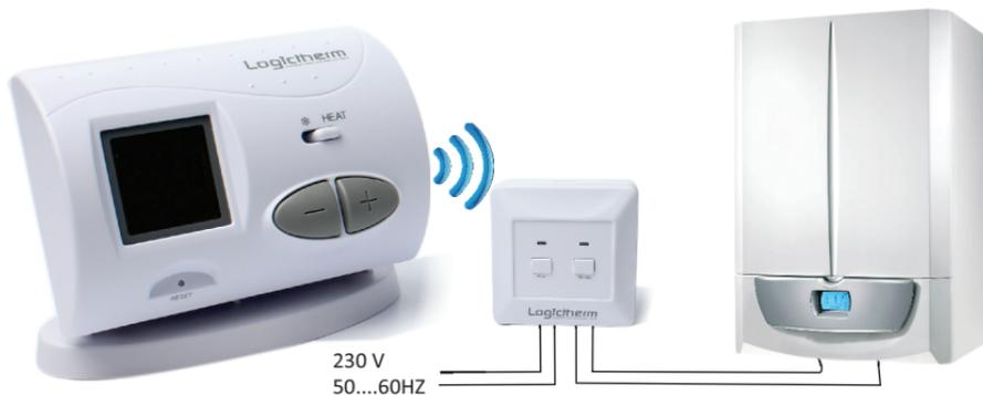
Il termostato è previsto di un numero di serie di fabbrica. Lo stesso numero è riportato anche sul ricevitore. In altre parole il termostato (l'emittente) e il ricevitore, sono coppie. Il termostato emittente e il ricevitore sono impostati dalla fabbrica a lavorare sulla stessa frequenza e hanno lo stesso codice di indirizzo, al fine di comunicare soltanto tra di loro.
